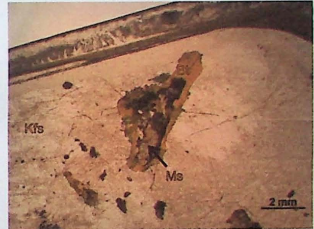
Figura A1.4: Fotomicrografia de sienito hololeucocrático exibindo cristal de clinopiroxênio substituído por opacos, muscovita e óxidos envolto por biotita. Amostra ISS100 com luz polarizada.
