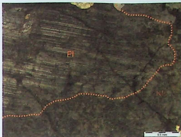
Figura A2.2: Fotomicrografia de melassienito exibindo possível xenocrystal de plagioclásio em contato difuso com álcali-feldspato sienito. Amostra ISS007 C 01 com polarizadores cruzados.
