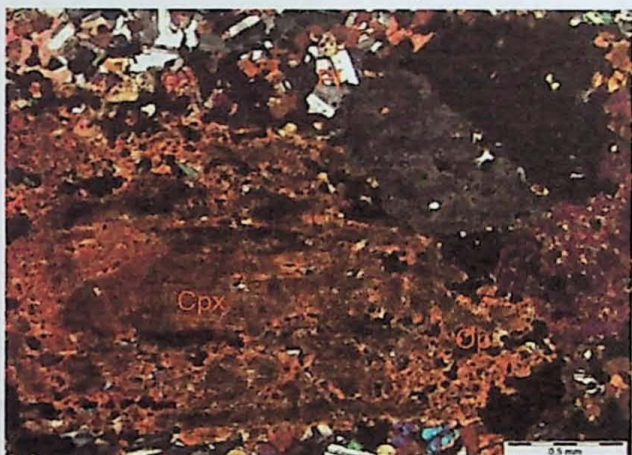
Figura A4.3: Fotomicrografia de metadiabásio com macrocristal de augita (Cpx) com sobrecrecimento marcado por regiões com muitas inclusões de opacos. Amostra ISS004 K 01 com polarizadores cruzados.
