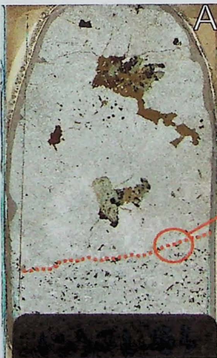
Figura A1.3: Fotomicrografia de sienito hololeucocrático apresentando um cristal de clinopiroxênio da série diopsídio-hedenbergita associado a titanita, opaco e biotita. Amostra ISS001 A03 com luz polarizada.
