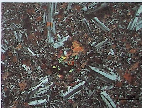
Figura A4.4: Fotomicrografia de metadiabásio com aglomerado de olivina e macrocristal de plagioclásio e augita em matriz fina granoblástica de plagioclásio. Amostra ISS004 B 01 com polarizadores cruzados.
