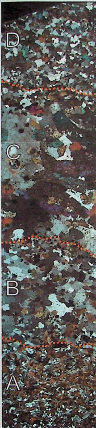
Figura A5.1: Fotomicrografia de melassienito em campo exibindo: A - microgabro com plagioclasio ripiforme suborientado formando bandas incipientes; B - metalucogabro com cristais de plagioclasio granoblásticos; C - vênula de álcali feldspato sienito; D - metadiabásio com cristais de plagioclasio granoblásticos. Amostra ISS105 C sob polarizadores cruzados.
