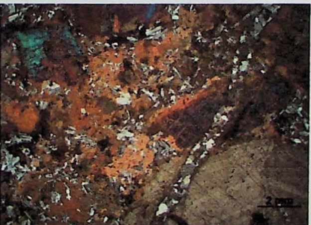
Figura A3.3: Fotomicrografia de gabro apresentando textura subofítica e veio de anortosito com textura granoblástica. Amostra ISS103 A 01 com polarizadores cruzados.
