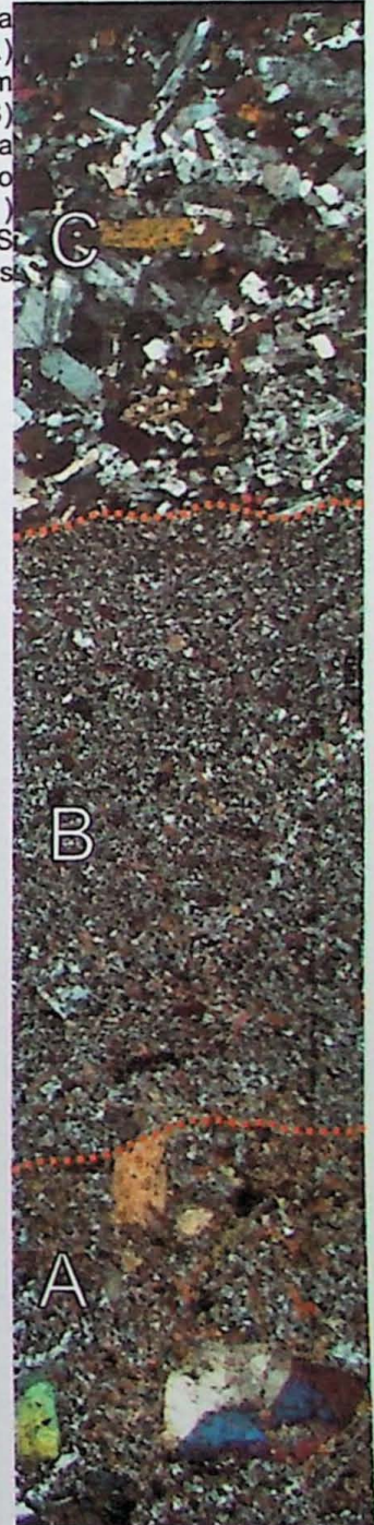
Figura A5.2: Fotomicrografia de gabro exibindo o contato entre um veio de microssienito com quartzo (direita) e metadiabásio cortado por vênula metaanortositica, ambos com textura granoblástica predominante (centro), em contato com gabro cumulático com mineirais intercumulus com contatos poligonalizados. Amostra ISS103 A 02 sob polarizadores cruzados.
