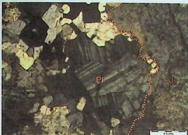
Figura A2.1: Fotomicrografia de melassienito exibindo contato abrupto entre anortosito (esquerda) com plagioclásio granoblástico e álcali-feldspato sienito (direita). Amostra ISS007 C 01 com polarizadores cruzados.
