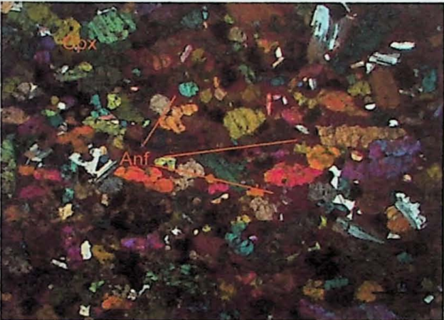
Figura A3.2: Fotomicrografia de melagabro de textura cumulática exibindo cristais subédricos de augita suborientados e kaersutita poquilítica no intercumulus. Amostra ISS104 A com polarizadores cruzados.
