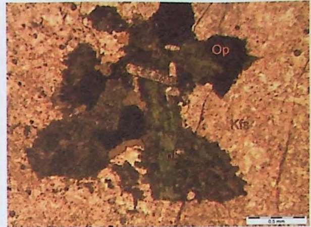
Figura A1.2: Fotomicrografia de sienito hololeucocrático apresentando aglomerado de minerais máficos composto por clinopiroxênio euedrico substituído por uralita associado a opacos manteado por biotita e apatitas prismáticas ou subarredondadas. Amostra ISS004 L 01 com luz polarizada.
