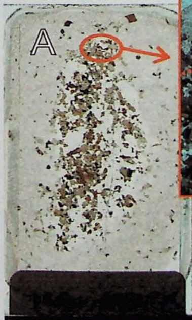
Figura A5.4: (A) Lâmina escaneada e (B) fotomicrografia evidenciando xenólito de gabro (em baixo) em contato abrupto com o sienito hololeucocrático (em cima). Amostra ISS103 C 02 com polarizadores cruzados.
